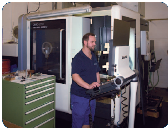
Jeden z moderních strojů společnosti FINAL Tools a. s., vertikální obráběcí centrum DECKEL MAHO 635V při práci.
