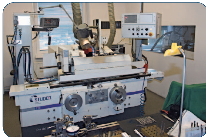
Broušení nástrojů s břity ze slinutých karbidů a diamantů probíhá na samostatném klimatizovaném pracovišti.
