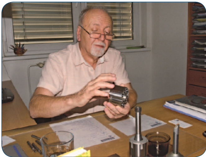
Ukázka hydraulického komponentu s obrobenými přesnými děrami.
