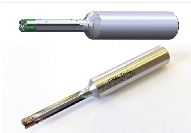
Obr. 3. Výstružník s novým utvářečem třísek Final Tools
