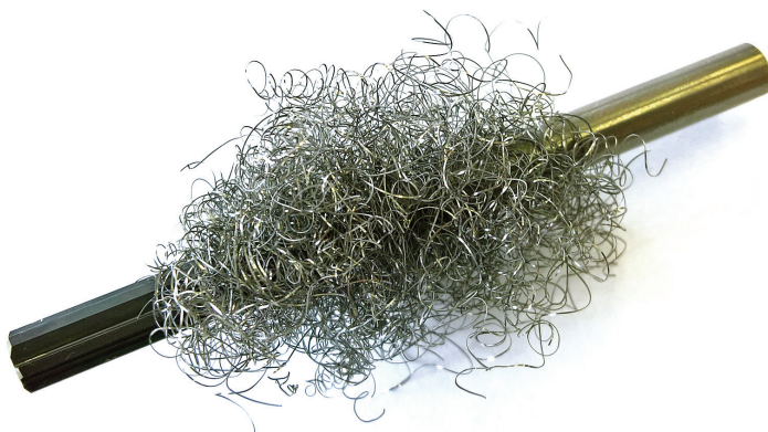
Obr. 1. Původní výstružník s nevhodně utvořenou třískou
