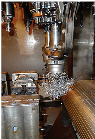
Obr. 4. Nevhodně utvořené třísky namotané na stopku výstružníku
